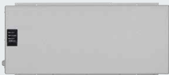
Система USV За преодоляване на прекъсвания на електрозахранването до 4 часа, защитните механизми, сигналните лампи и др. продължават да функционират, LED-индикация за състоянието, автоматично тестване на батерията, филтър за пренапрежение, Размери: 560 × 235 × 260 мм (Ш × В × Д), Вид защита: IP 20
